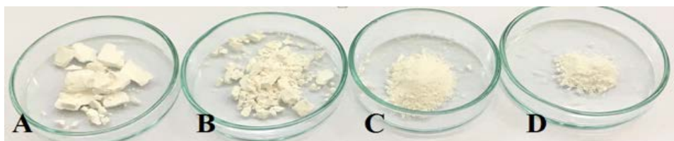
Slika 2. Vizualna prezentacija polimorfne oblike III pridobljene z različnimi kristalizacijskimi tehnikami: A – spontana kristalizacija, B – kristalizacija s cepljenjem, C – dodatna deaglomeracija, D – uporaba ultrazvoka med procesom kristalizacije.
